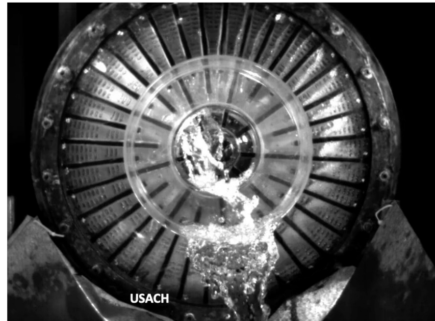
L Magne, G Titichoca, A Gutiérrez, 2008 Molino 60 cm, a escala de 36 pies, tapas transparentes, USACH Videos de alta velocidad y alta resolución
