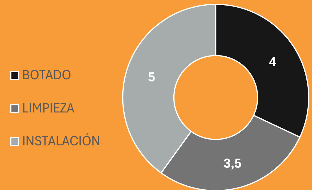
Tiempo de Ejecución Actividades Directas (minutos) Revestimiento Híbrido (Pza: Lifter Alimentación o Descarga)
